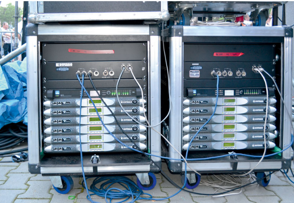
Wszystkie zestawy pędzone były z czterech amp-racków (po dwa na stronę) zawierających w sumie 24 wzmacniacze Outline T11 (T Eleven), zaś każdy z raków dysponował procesorem Lake LM26.
