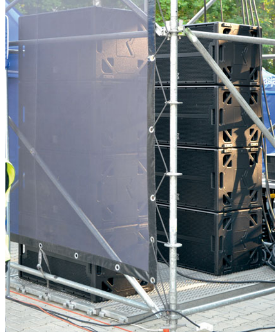
...plus po 8 subbasów GTO-SUB, w układzie end fired, na stronę.
